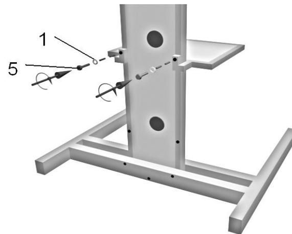
Установите полку на нужную вам высоту и зафиксируйте ее болтами
