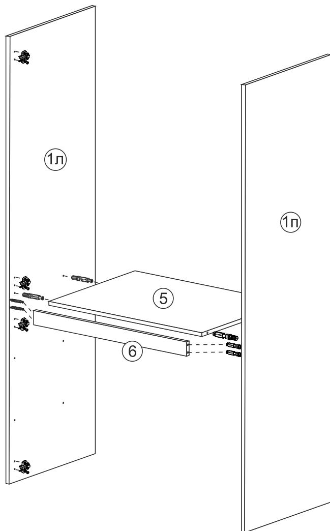
2. Предварительно на боковины 1л и 1п установить эксцентрики и прикрепить ответные планки петель евровинтами 6,3\*10,5 мм.
