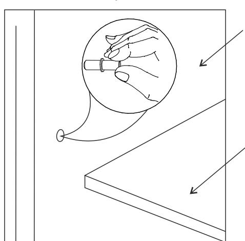
6. На створки 8, 9, 10 и 11 установить петли шурупами 4\*13 мм. Для установки ручек на створку необходимо досверлить глухое отверстие диаметром 5 мм насквозь. Далее закрепить ручки саморезом и навесить фасад.
