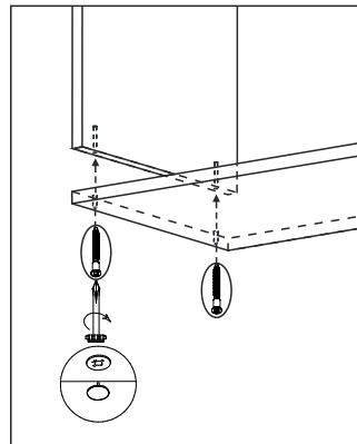
5. Крышку 3 соединить с боковинами при помощи еврошурупов. Ножки прикрепить к нижней крышке 2 при помощи шурупов 4\*30 мм.
